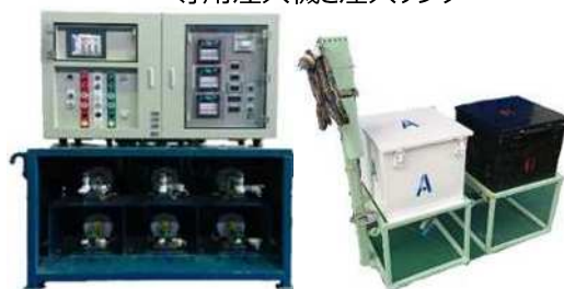
専用注入機と注入タンク
